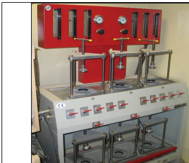
Рис. 3. Установка прямого определения водонепроницаемости WE 6 MM
