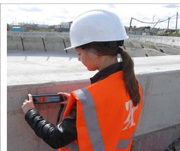
Рис. 12 Измерения прибором RESIPOD в натуральных условиях
