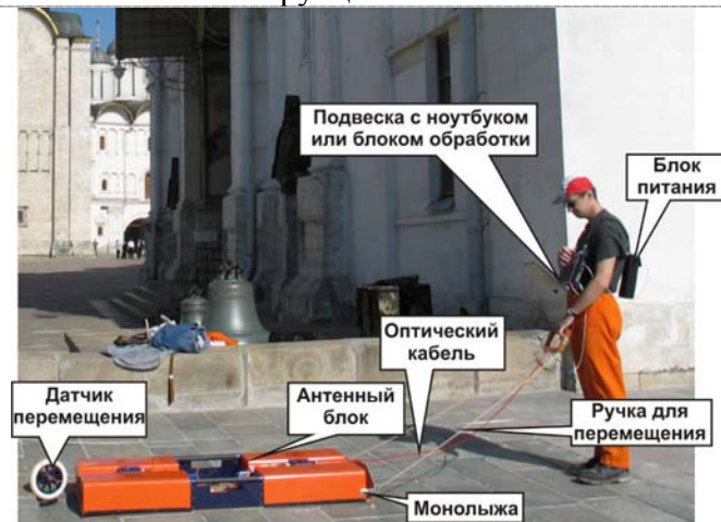
Рис. 18 Внешний вид типичного георадара с экранированной антенной
